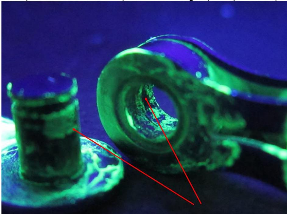
2) BETWEEN THE OUTSIDE OF THE SPIGOTS AND THE ROLLERS
